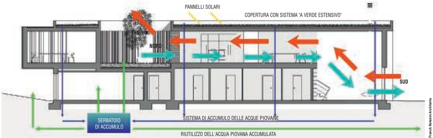
Sezione longitudinale BB. Scala 1:200. I sistemi di risparmio energetico
